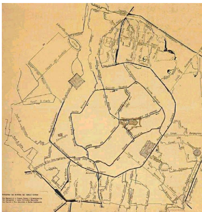
Fig. 4.4: il progetto Bignami-Cesa Bianchi per la fognatura del centro storico (1868) (da "La rete fognaria di Milano" di G.L. Lapini)
