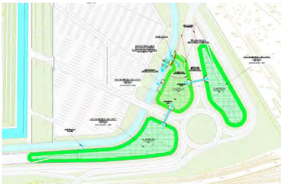
Figura 5-6. Vasche di laminazione del torrente Guisa.
