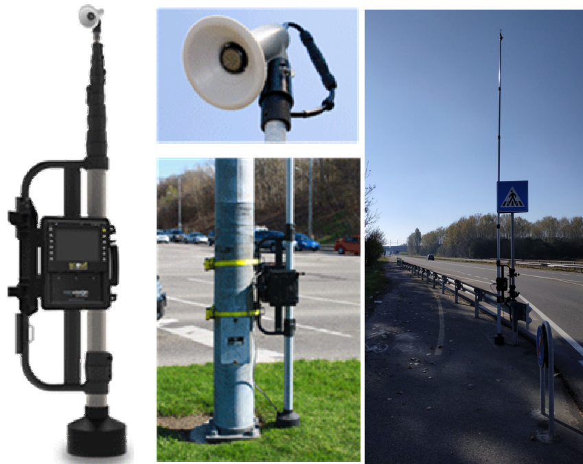
Figura 13 – Strumentazione video con palo telescopico
